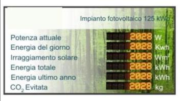
Display LED da interno / esterno per visualizzazione N°6 parametri impianto fotovoltaico (Potenza attuale, Energia del giorno, Campo irraggiamento, Energia totale, Energia ultimo anno, CO2 evitata), comunicazione RS485, led giallo ambra. Con grafica personalizzabile, schermo antiriflesso, regolazione luminosità automatica tramite sensore crepuscolare, visibilità fino a 50 mt. Dimensioni B. 2400 x H. 1350 x P. 75 mm, altezza caratteri 120 mm, peso 28kg.
