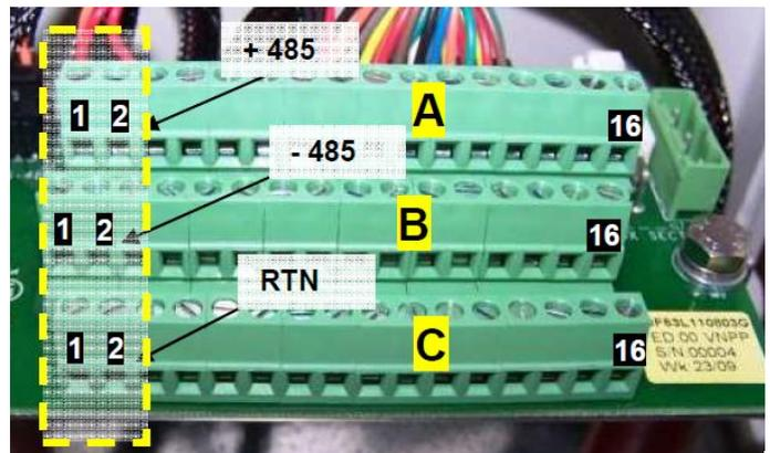
Per il cablaggio del controllore di stringa al datalogger utilizzare sempre un cavo twistato schermato con spessore AWG 20/22. Essendo cavi con segnali di tipo SELV attenzione a non far passare il cavo in prossimità di cavi di potenza per non disturbare il segnale dalle possibili interferenze dell'impianto
