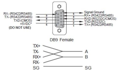
Per il cablaggio del controllore di stringa al datalogger utilizzare sempre un cavo twistato schermato con spessore AWG 20/22. Essendo cavi con segnali di tipo SELV attenzione a non far passare il cavo in prossimità di cavi di potenza per non disturbare il segnale dalle possibili interferenze dell'impianto
